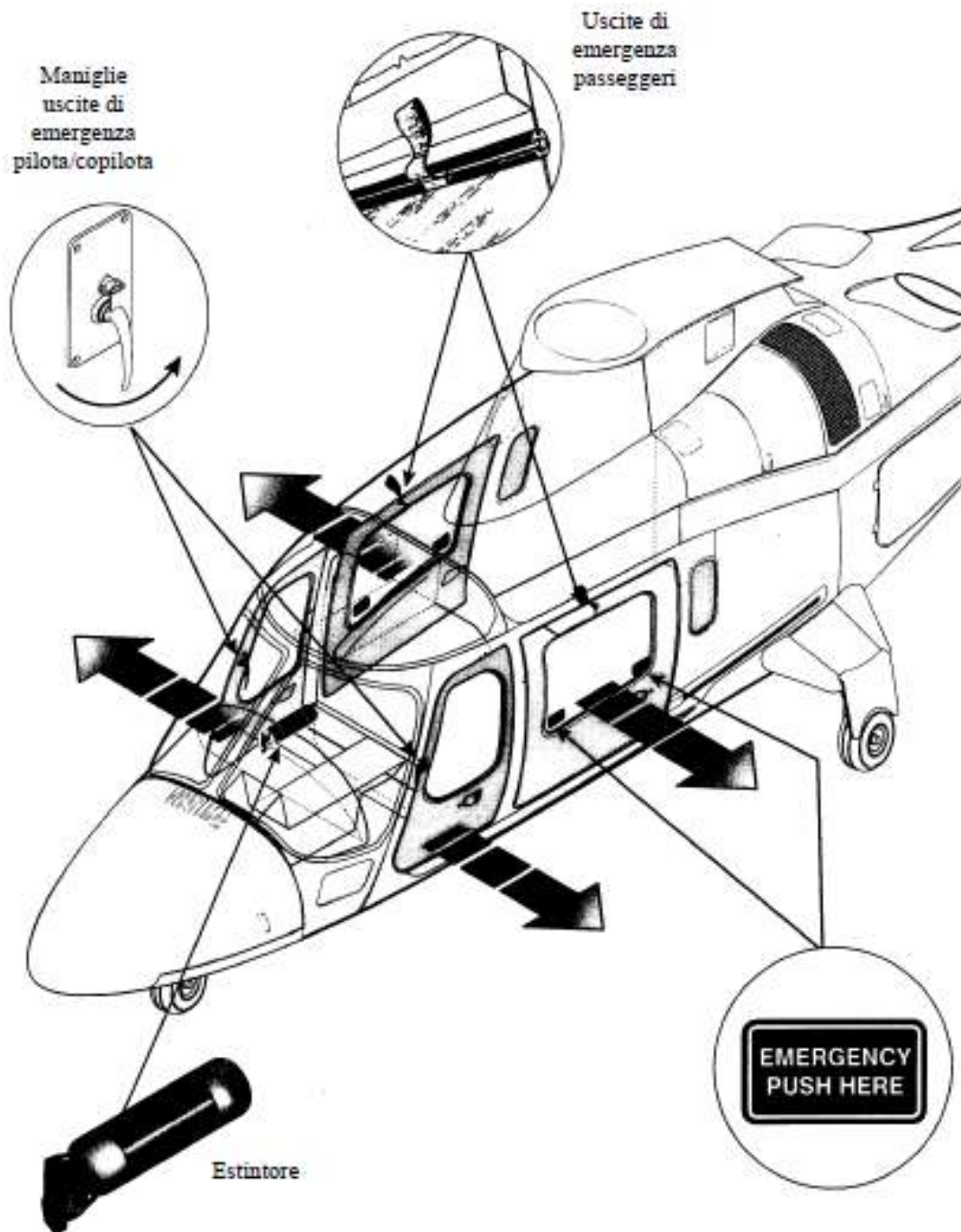
Localizzazione uscite di emergenza ed estintore
