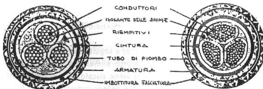
Fig. 31 - Conduttori per linea elettrica in Cavo
