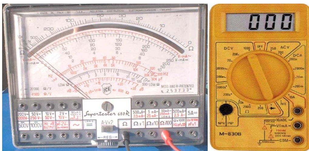
Fig. 16 - Multimetro analogico ( a sinistra) e multimetro digitale ( a destra)
