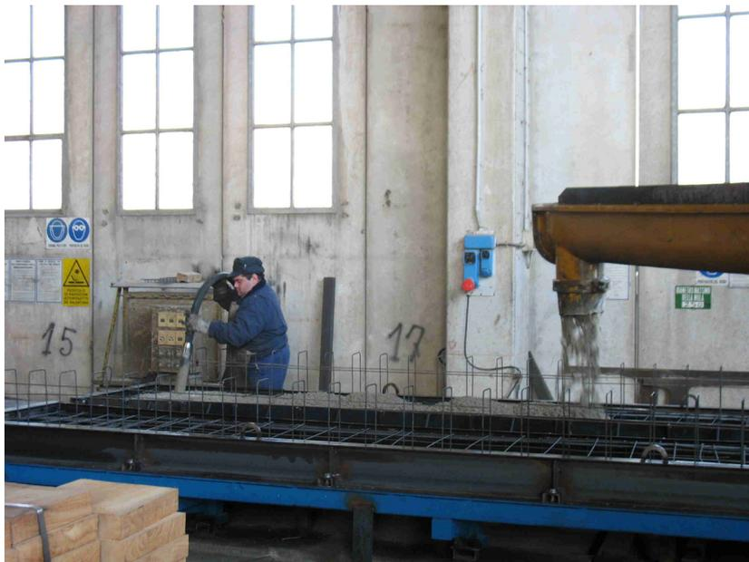
Figura 30 - La fase del getto e della vibratura in uno stabilimento
