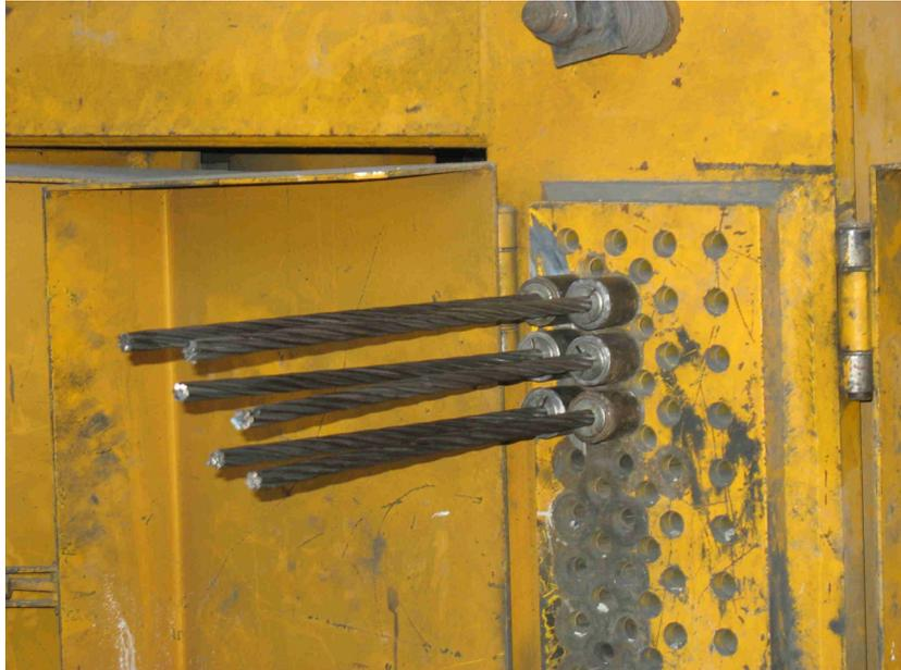
Figura 32 - Particolare della testata in una pista di precompressione
