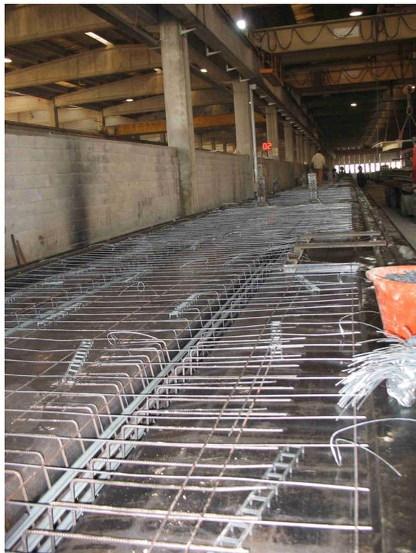
Figura 33 - Pista di precompressione per la realizzazione di tegoli, si noti l'armatura lenta
