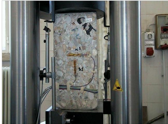
Figura 19 Campione di prova sottoposto a compressione
